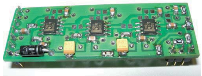
Abb. 6: Verstärkermodule für octal fast amplifier-Kassetten
