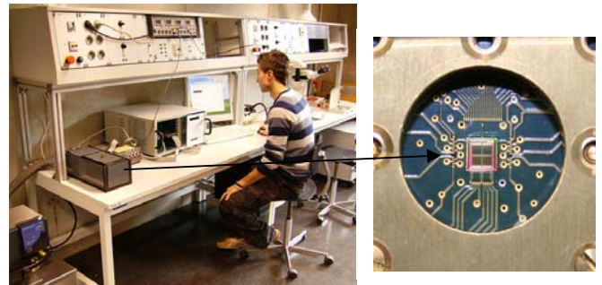
Abbildung 2: Links: Aufbau im Technologielaor zur Sensor-Charakterisierung. Rechts: Detailansicht eines MAPS Prototyps MIMOSA-11.
