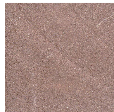
ABBILDUNG 45 Sandstein („roter Main-Sandstein“), weitgehend aus Quarz bestehend. Die rötliche Färbung ist Hämatit zuzuschreiben. Das Bindemittel (nicht sichtbar) ist tonig.
