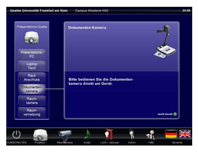
Der grüne Punkt "Gerät bereit" zeigt an, dass ein Bildsignal der Kamera erkannt wurde. Leuchtet die Taste nicht ist die Kamera noch ausgeschaltet oder es liegt eine anderweitige Störung vor
