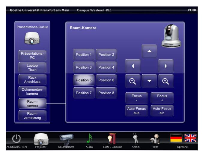
Hat man den Menüpunkt "Raumkamera" im Feld "Projektions-Quelle" ausgewählt, wird das Bild der Kamera zur Projektion übertragen. Mit den Bedientasten kann die Kameraposition eingestellt werden, welche auf den 8 Positionstasten als Preset gespeichert werden kann. Hierzu hält man ein der Tasten für 3 Sekunden gedrückt. Um eine gespeicherte Position wieder abzurufen genügt ein kurzer Druck auf die entsprechende Taste.
