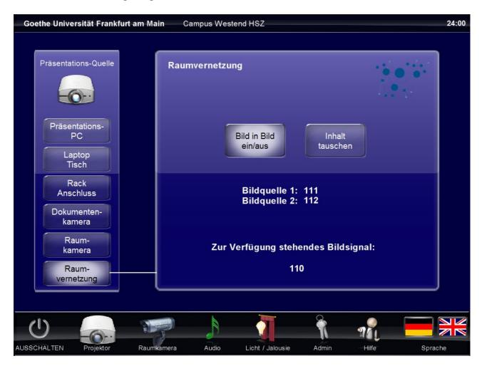
Der Platzhalter 110 wird nun "PIP" anzeigen. An den Positionen der Platzhalter 111 und 112 ist abzulesen, welche beiden Signale auf den Bild-in-Bild Generator geroutet wurden. Mit der Taste "Bild in Bild ein/aus" kann das kleine Videofenster auf der Projektion einund ausgeblendet werden. Die Taste "Inhalt tauschen" tauscht den Inhalt des kleinen Fensters mit dem großen Bild im Hintergrund.
