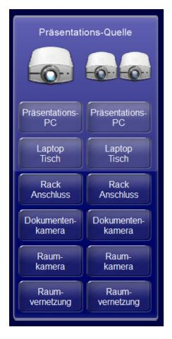
Die beiden äusseren Projektoren zeigen immer das gleiche Bild an, der mittlere Projektor kann unabhängig davon mit einem Signal belegt werden. So ist es möglich z.B. die Präsentation in die Mitte zu legen, während das Kamerabild links und rechts zu sehen ist.
