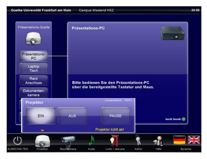
In diesem Menü kann der Projektor ein- und ausgeschaltet werden. Mit der Taste "Pause" wird das Bild dunkel geschaltet ohne jedoch den Projektor völlig auszuschalten. Ein erneuter Druck auf diese Taste aktiviert das Bild wieder.
