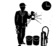
Arbeitsstelle und nähere Umgebung (ggf. bis 10 m) freimachen. Alles was brennen kann, soll möglichst weggeräumt werden; insbesondere leichtentzündliche Gegenstände wie Papier, Textilien, Druckbehälter und Behältnisse mit brennbaren Flüssigkeiten oder Brenngas.
