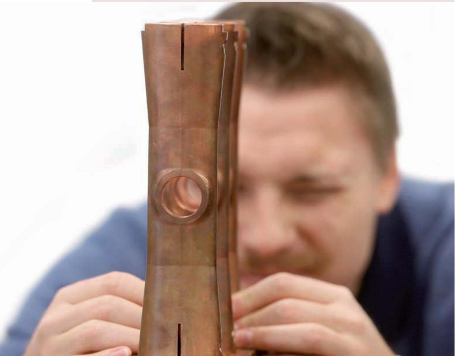
Proben für den Ernstfall: In Versuchen an Modellen testen Physiker, ob die geplante Beschleuniger-Architektur funktioniert. Hier werden aus Kupfer angefertigte Komponenten des Modells zusammengesetzt und justiert. Durch die Mitte wird der Teilchenstrahl gehen.
